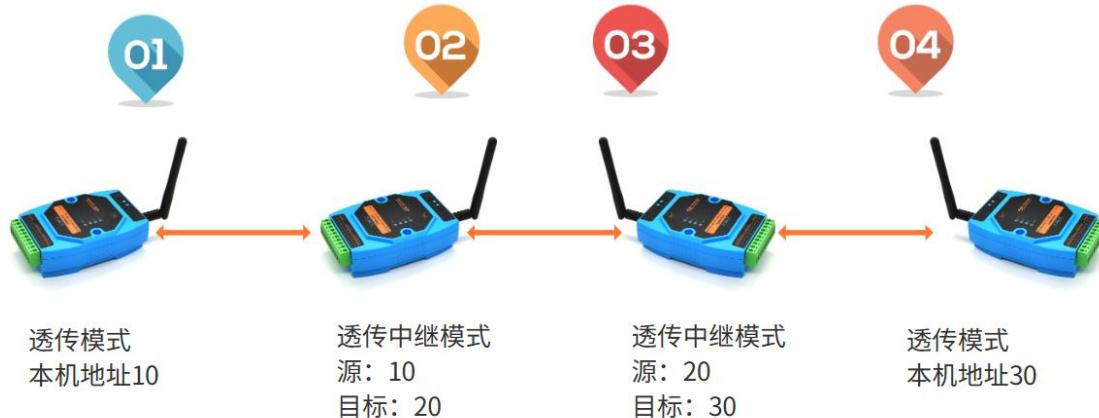
电台 1、2、3、4 号的无线信道和速度都一样。电台 1 号、4 号配置为透传模式，电台 2、3 号配置为透传中继模式。
