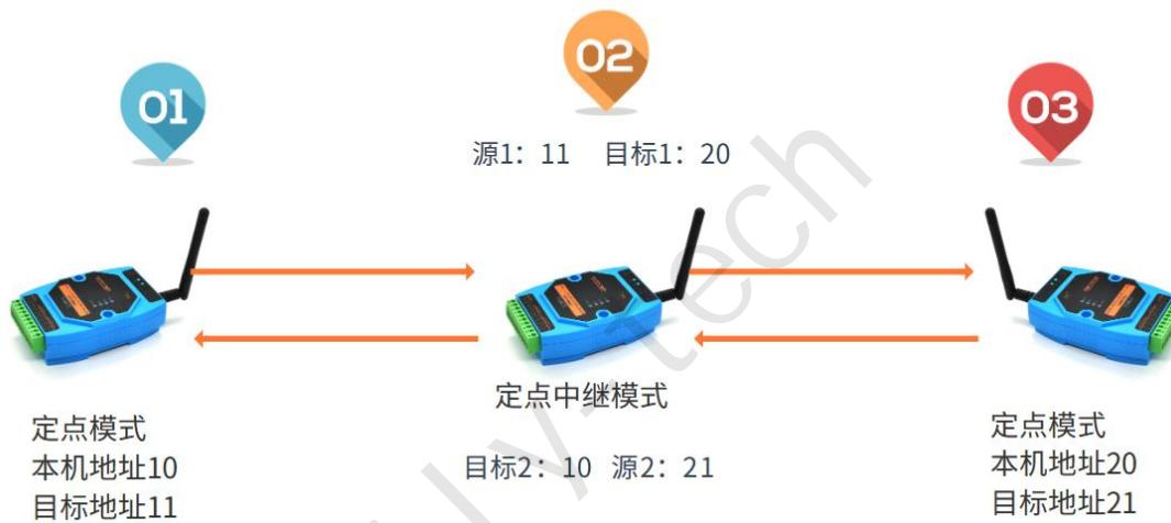
电台 1、2、3 号的无线信道和速度都一样。电台 1 号、3 号配置为定点模式，电台 2 号配置为定点中继模式。
